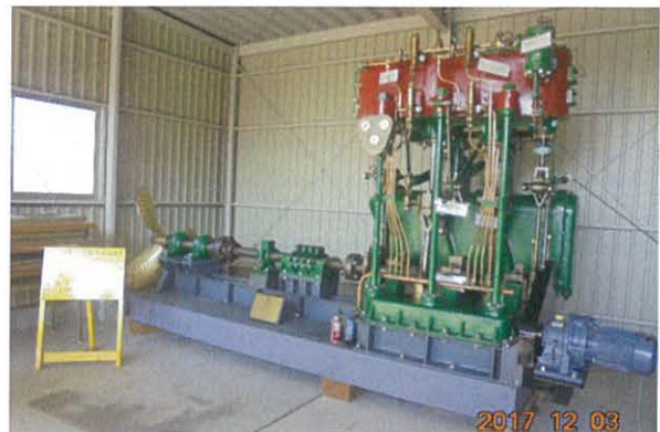
図2 『二段膨張式船舶用蒸気エンジン』 (日本機械学会「機械遺産」第79号)
