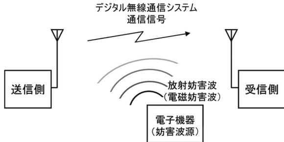
図 5: 電子機器から放射される電磁妨害波と被干渉デジタル無線通信システム<sup>[11]</sup>
